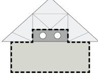
INVERTED SOFFIT OR MODIFIED TRUSS
